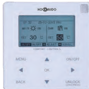
Betriebsmodus HEIZEN + BWB
