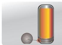
Weitere Rohrwicklung am Boden des Tanks "Nesteffekt" (höheres Brauchwarmwassernutzvolumen)
