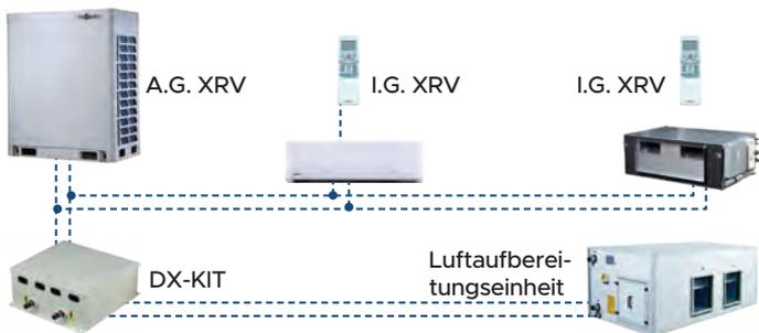
Schema Typ B: nur Luftaufbereitungseinheit
