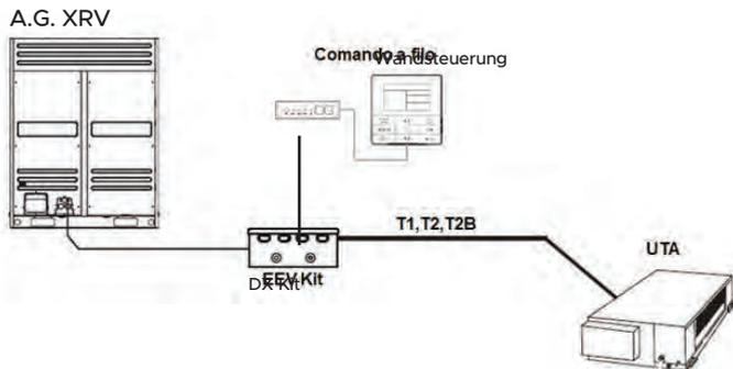
Die Temperaturregelung der Räume erfolgt nach der gleichen Logik wie bei einem XRV: durch den Vergleich der vom T1-Sensor erfassten Temperatur mit der Einstelltemperatur Ts, kann das Außengerät gestartet oder gestoppt, die erforderliche thermische Belastung berechnet und der Kältemittelfluss durch das elektronische Expansionsventil gesteuert werden.
