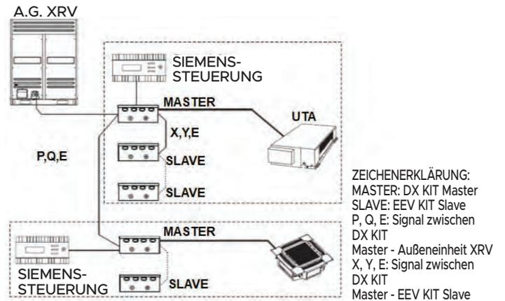
Bei Parallelschaltungen mehrerer DX-KITs zu einer Luftaufbereitungseinheit ist die Logik der zu verfolgenden Verbindung diejenige des Master-Slave.
