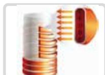
Scambiatore piatto a microcanali in alluminio (maggiore superficie di contatto col serbatoio e migliore scambio termico)
