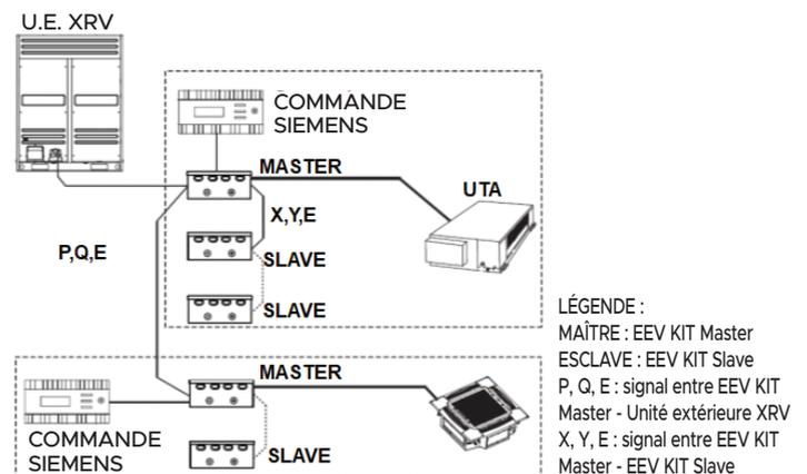
En cas de liaisons parallèles de plusieurs EEV-KIT au service d'une UTA, la logique de connexion à suivre est celle Master-Slave.
