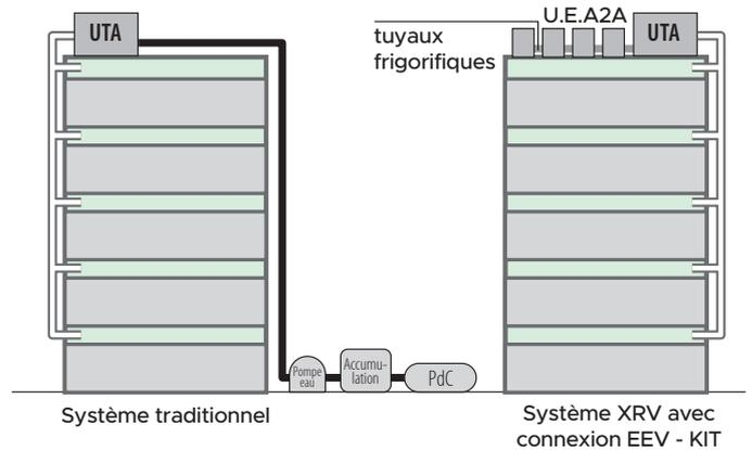
EEV-KIT permet de raccorder des batteries à expansion directe d'unités de traitement d'air à des systèmes XRV.
