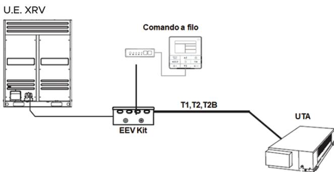
Le contrôle de la température des pièces se fait en suivant la même logique qu'un XRV : en comparant la température relevée par le capteur T1 et la température de réglage Ts, il est possible de démarrer ou d'arrêter l'unité extérieure, calculer la charge thermique requise et de gérer le flux de réfrigérant au moyen du détendeur électronique.
