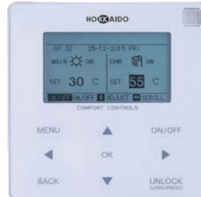
Mode de fonctionnement CHAUFFAGE + ACS
