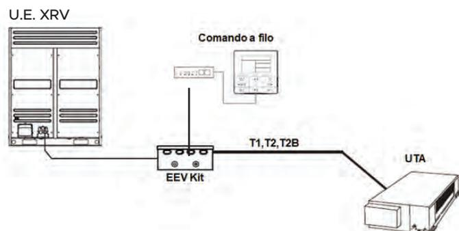
Le contrôle de la température des pièces se fait en suivant la même logique qu'un XRV : en comparant la température relevée par le capteur T1 et la température de réglage Ts, il est possible de démarrer ou d'arrêter l'unité extérieure, calculer la charge thermique requise et de gérer le flux de réfrigérant au moyen du détendeur électronique.
