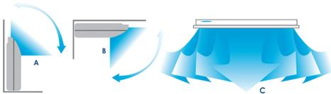
Installation flexible : possibilité d'installation également dans les angles du plafond, s'il n'est pas possible d'installer l'unité au centre de la pièce à cause de la présence d'obstacles éventuels.
