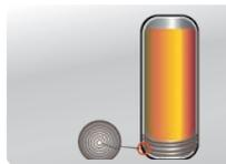
Enroulement ultérieur tube sur le fond du réservoir « effet nid » (volume utile ACS supérieure)
