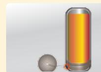
Углубленная обмотка трубки на дне резервуара «эффект гнезда» (более высокий полезный объем ГВС)
