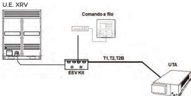
Il controllo della temperatura dei locali avviene con la stessa logica di un XRV: comparando la temperatura rilevata dal sensore T1 e la temperatura di settaggio Ts, è possibile far partire o arrestare l'unità esterna, calcolare il carico termico richiesto e gestire il flusso di refrigerante tramite la valvola di espansione elettronica.
