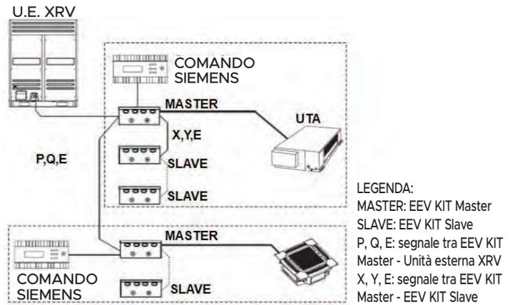
Nel caso di collegamenti in parallelo di più EEV-KIT a servizio di un'UTA, la logica del collegamento da seguire è quella Master-Slave.
