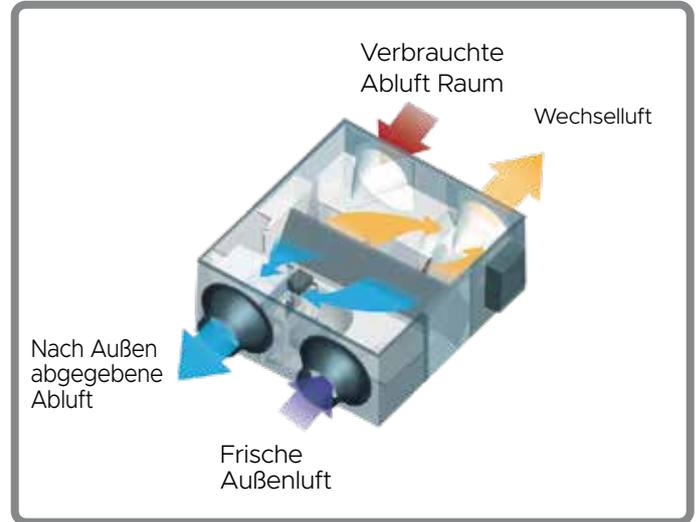
**Gesamtwärmerückgewinner. Zur Energierückgewinnung während des Luftaustauschs in den Räumen**
